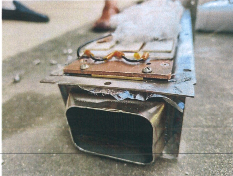
图2 能隙发热设备出风口（尺寸 70mm×50mm）
